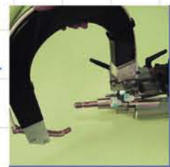
Uアームを差し込み、 レバーを締め込み。
