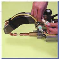
アーム交換開始。 カブラはワンタッチで外せ、 水漏れ無し!! ※1
