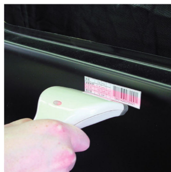
パーツの溶接部位にシール貼付
