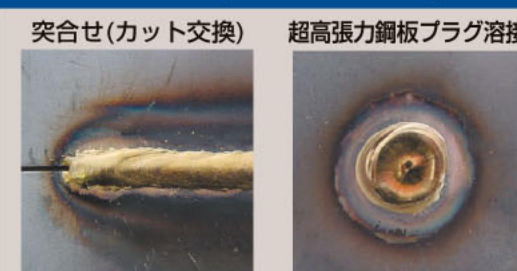
超高張力鋼板が交換部位にも使用が開始されたことで、今、MIGブレージングによる接合がクローズアップされています。
