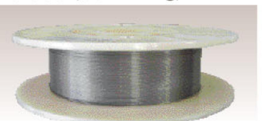
溶接金属は、溶接直後で約890MPa、自硬硬化後で約1,100MPaという高い強度があり、超高張力鋼板の溶接に最適です。
