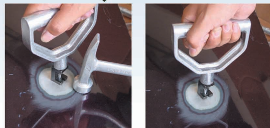
ハンドプーラー 簡単なハンマリング 作業等に使用します
