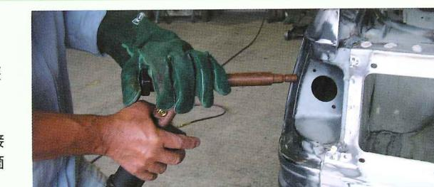
注：片面作業では溶接条件の1つ“加圧力”を損ないますので、溶接の品質保証を行うことはできません。片面作業は溶接強度の必要な箇所にご使用ください。
