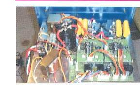
その頭脳をつかさどるメイン回路に、IGBTインテリジェントパワーモジュールを採用。最新のインバータテクノロジーを駆使し、小さなボディに高性能回路を効率よく搭載しました。低価格をキープしながら、相反する電源効率と出力がさらにランクアップしました。
