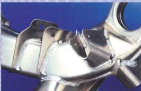
自動車メーカーでのアルミ製サブフレームへのサフラ溶接ワイヤ使用例
