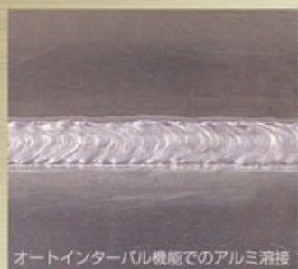
オートインターバル機能でのアルミ溶接
