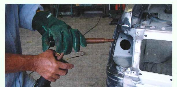
注：片面作業では溶接条件の3条件の1つ“加圧力”を損ないますので、溶接の品質保証を行うことはできません。片面作業は溶接強度の必要ない箇所にご使用ください。
